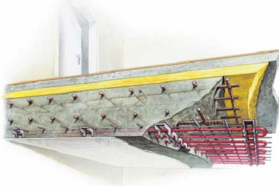
**Abbildung 6: Schematische Darstellung eines Deckenheiz- und Kühlsystems (Hybridsystem) in einer Massivdecke. (Bild: RCS, System Climacool RBO-90)**
