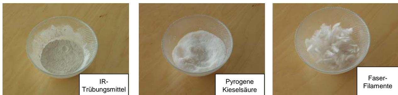
Bild 1: Komponenten einer Standardmischung für Wärmedämmplatten
